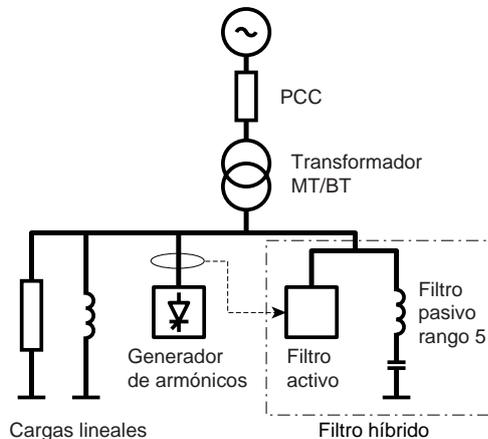
**Fig. 12:** Aplicación e instalación de la solución.
