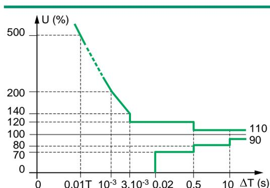
Fig. 4: Tolerancia típica definida por la curva ITI.
