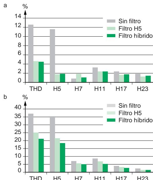
Fig. 14: Espectros mostrando la eficacia de un filtro híbrido [a] en tensión, [b] en corriente.
